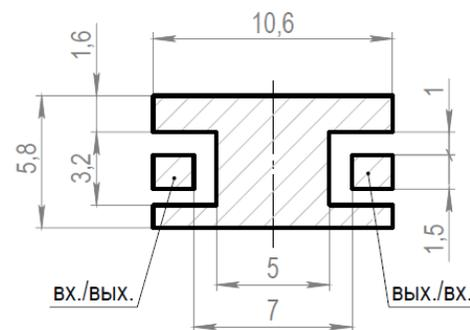
для монтажа на плату RO4003C IPC4103 толщиной 0,813 мм
