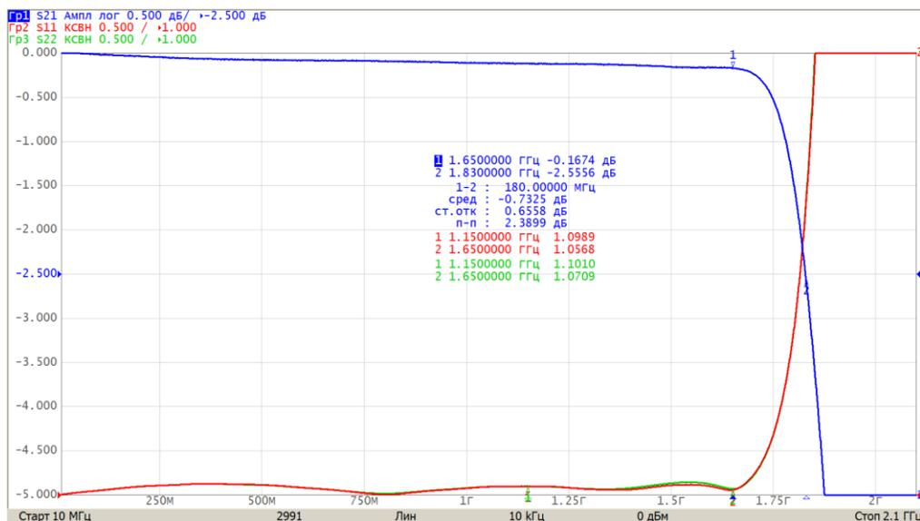
АЧХ и КСВН входа/выхода в полосе пропускания
